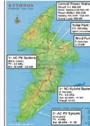
Energieversorgung mit Hybridsystemen auf Kythnos
